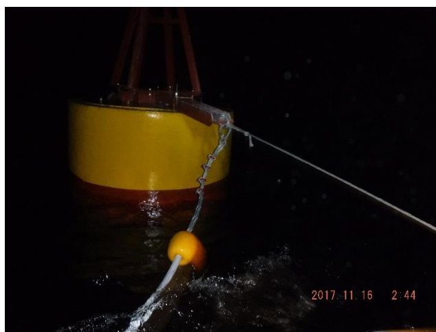
Figura 6.- Boya Tether unida por el brazo a cuerda con flotadores.
