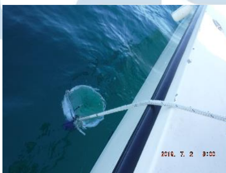
Fig. 13.- Arrastre con red cónica de 20 micras
