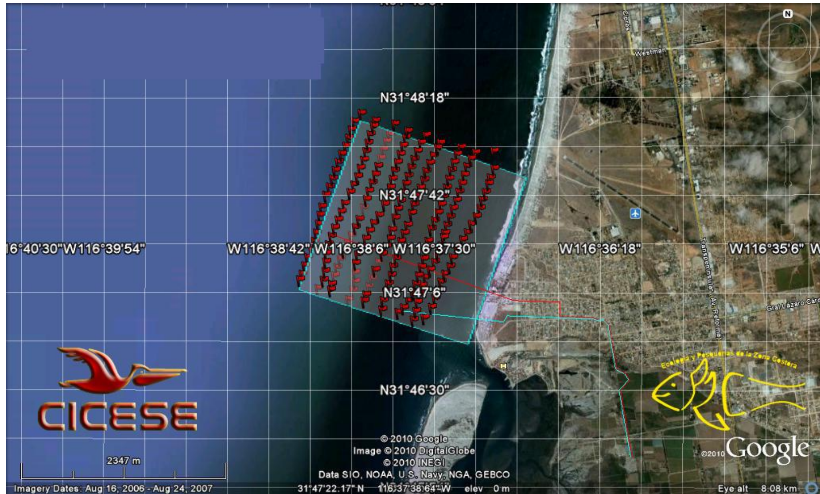
Figura 4. Localización de puntos de sondeo del 12 de enero de 2010. Las líneas roja y azul representan las obras de toma y descarga de agua respectivamente. El cuadro indica la zona donde se realizaron muestreos de organismos para determinación de zooplancton y bentos como parte del proyecto de la desaladora.
