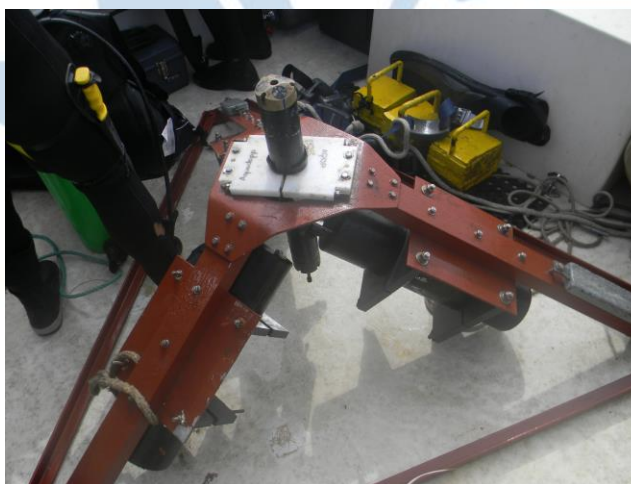
Figura 4.- Anclaje y pesos muertos (amarillos) en cubierta de la Rigel .
