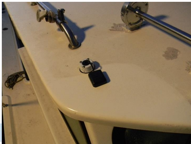
Figura 1.- Nueva antena de GPS de embarcación Rigel instalada y adherida con Velcro .
