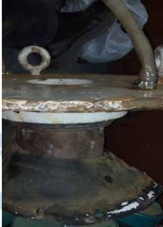
Fig. 3 – Tapa adaptadora, empaque de hule y ADCP fuera del nicho.
