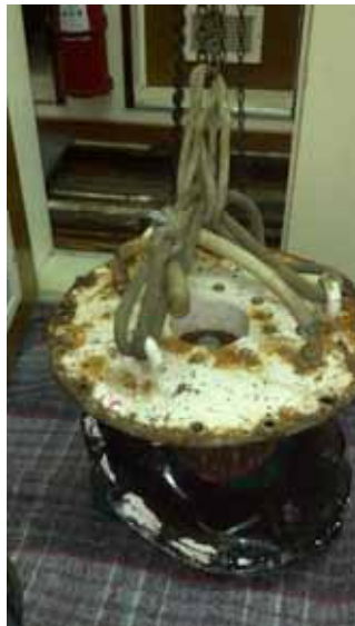
Fig. 29 – ADCP aún acoplado a la tapa del poceto, luego de ser sacado del mismo.
