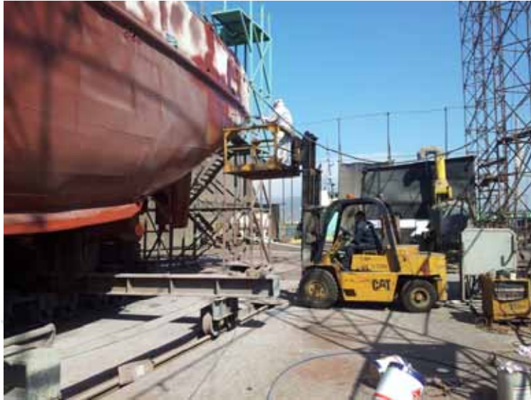
Fig. 17 – Aplicación de pintura base roja en el área de popa por la banda de babor.
