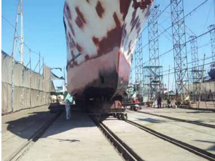
Fig. 30 – Aplicando la primera capa de pintura anti-vegetativa en color negro al casco.
