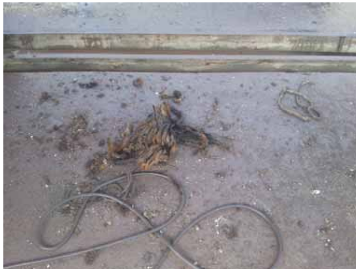
Fig. 4 – Trozo de red Bongo removida del buje marino del eje de cola.
