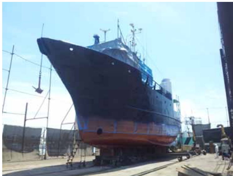
Fig. 35 – Terminada la aplicación de la capa de esmalte azul oscuro a obra viva, costado de babor.
