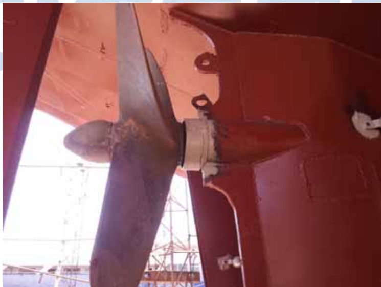
Fig. 45 – Guardacabo colocado y pintado entre eje y propela del buque.
