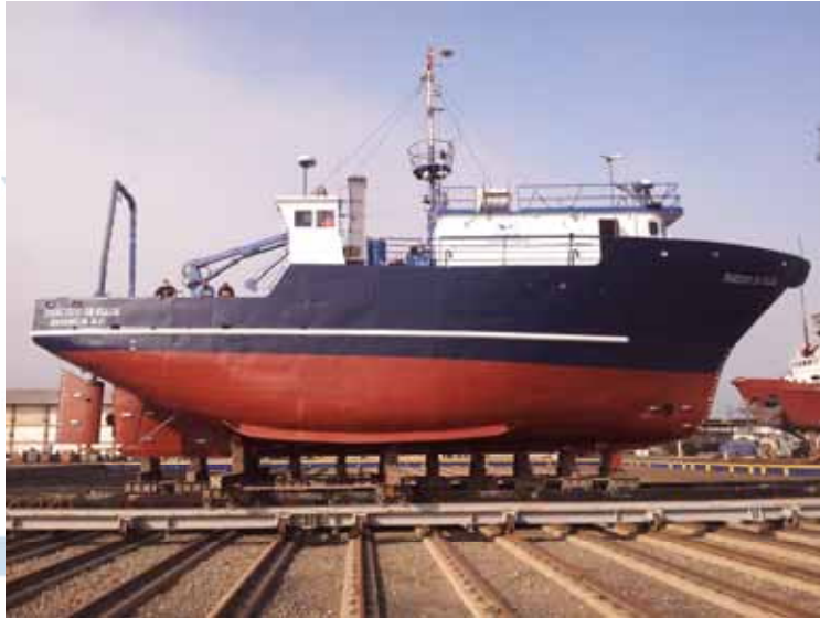
Fig. 50 – Buque en la cama de transferencia, siendo transportado al sincroelevador.
