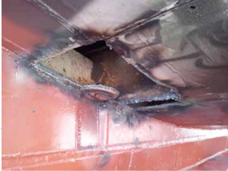
Fig. 38 – Corte de placa de casco cerca de la quilla, bajo cuarto de máquinas.
