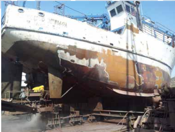
Fig. 6 – Continuando la remoción de pintura del casco.
