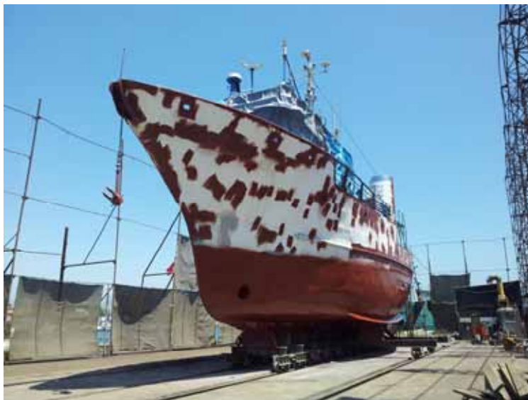
Fig. 31 – Terminada la aplicación de pintura anti-vegetativa en la obra viva del casco.
