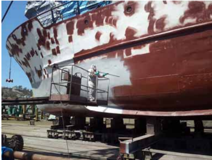
Fig. 26 – Aplicación de segunda capa de base clara a casco, costado de babor.
