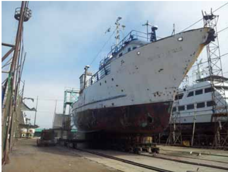
Fig. 5 – Buque siendo sometido a proceso de remoción de pintura con agua a presión.
