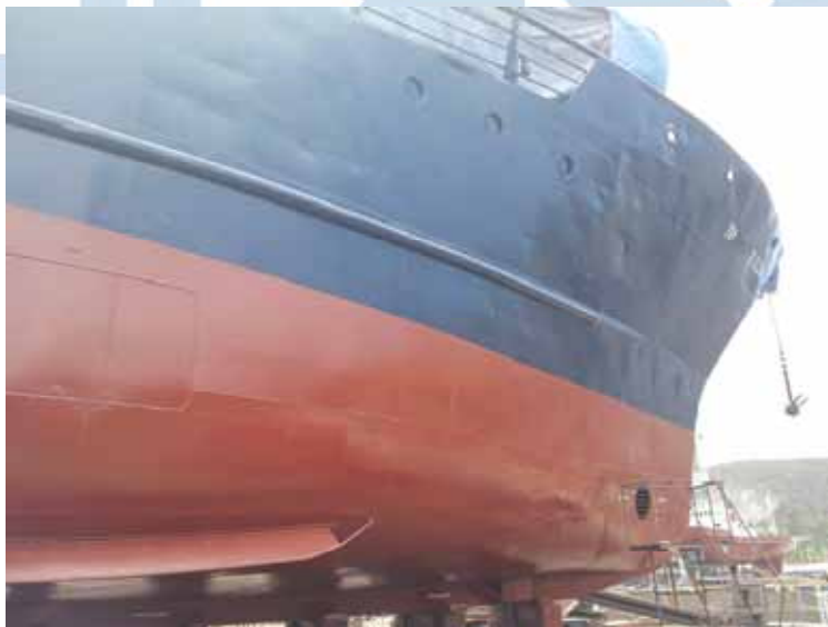
Fig. 39 – Pintura esmalte en obra viva, costado de estribor. El nombre del buque a medio pintar.
