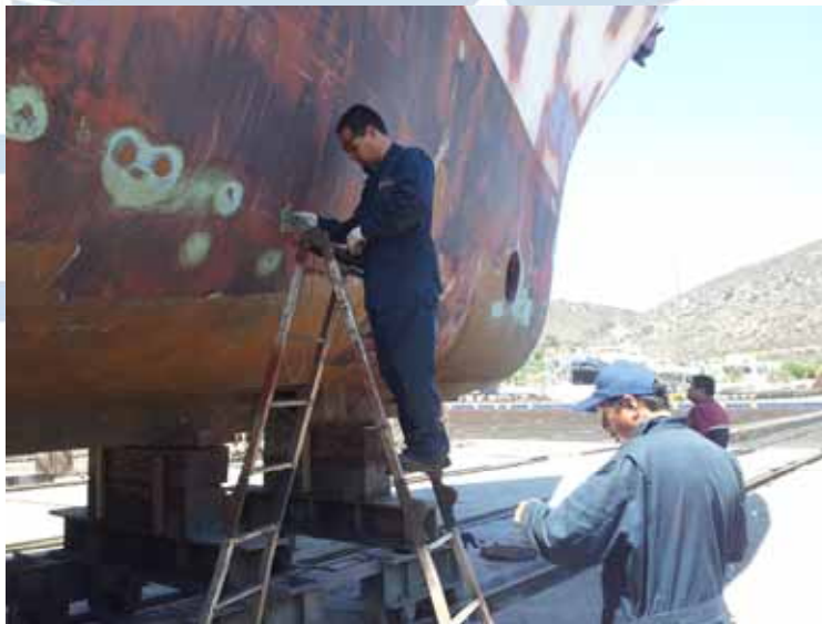
Fig. 10 – Personal de Ultrasonido Naval e Industrial tomando calibraciones ultrasónicas al casco.
