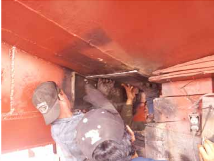
Fig. 42 – Personal del astillero presentando nuevo segmento de placa de área de máquinas.
