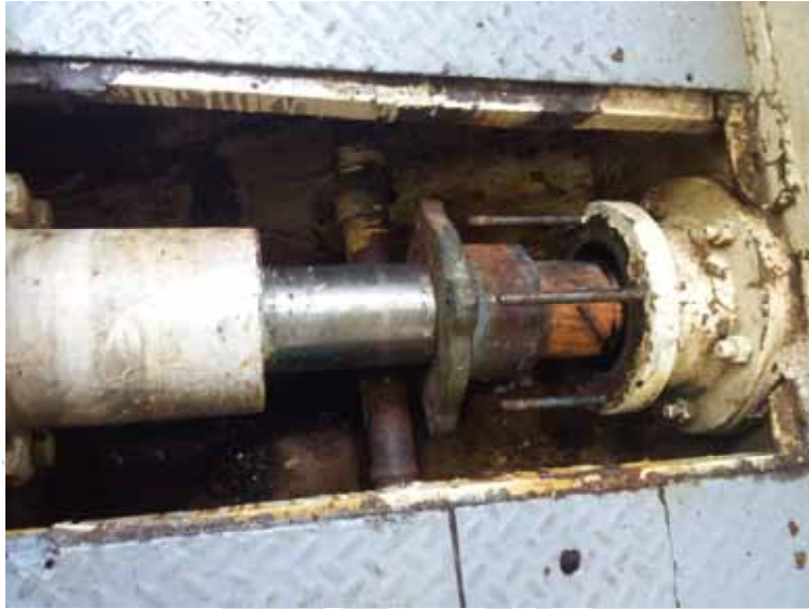
Fig. 11 – Parte interna del eje de propela, con empaque desmontado para revisión. Hacia la izquierda a la reductora, a la derecha a popa.
