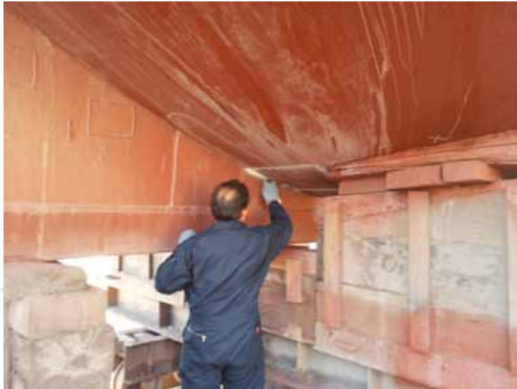
Fig. 19 – Realizando el marcado del área cercana a la quilla en máquinas a renovar (53cm x 55cm con placa de 5/16”), por parte del inspector titular de Ultrasonido Naval e Industrial.
