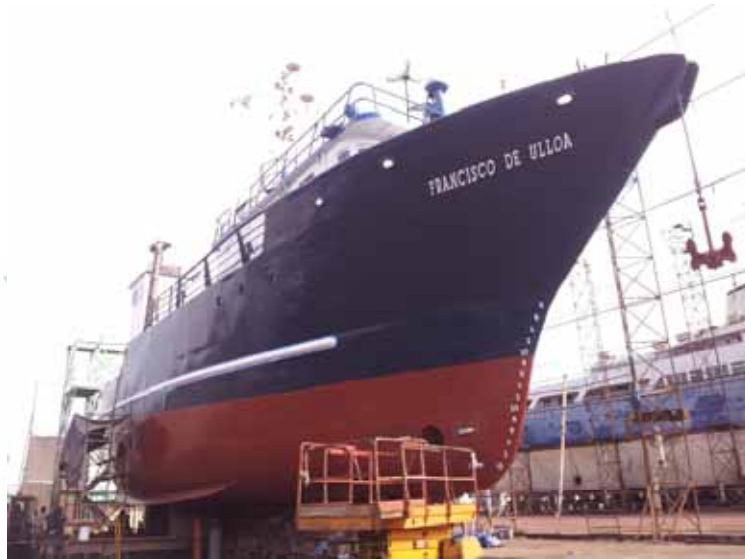
Fig. 40 – Costado de estribor de buque pintado, ánodos de zinc colocados y números de calado pintados en color blanco.
