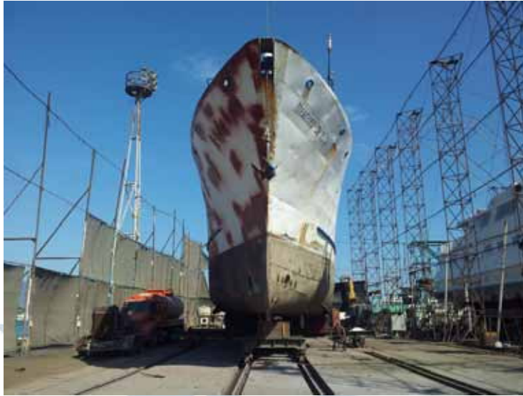
Fig. 9 – Toma de frente del buque. A la izquierda, la pipa de diesel para vaciado de uno de los tanques.
