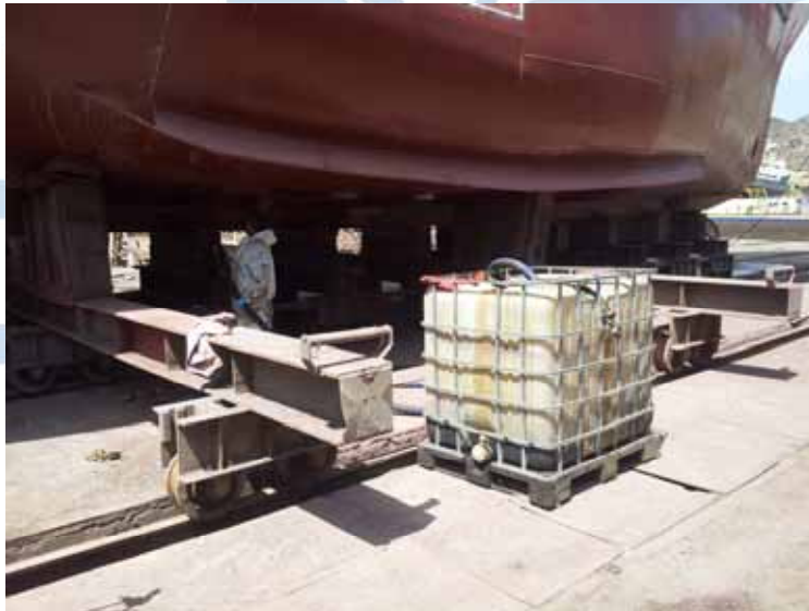
Fig. 23 – Extracción de contenido de la sentina de máquinas en proceso.
