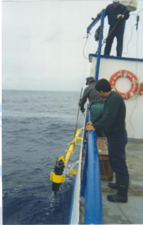
Foto 7. Extensión metálica (color amarillo) donde esta fijada la bomba de succión (color negro). Foto tomada desde la proa del B/O Francisco de Ulloa, por la borda de estribor. Se aprecia al fondo la base fija al casco (color amarillo) donde descansa la extensión para evitar golpeteo sobre el costado del barco durante la navegación.
