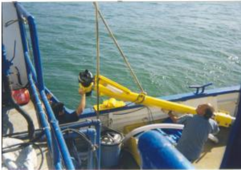
Foto 11. Durante los trabajos para desmontar el soporte externo de la bomba de succión, al principio del crucero IMECOCAL 9904 a bordo del B/O Francisco de Ulloa.
