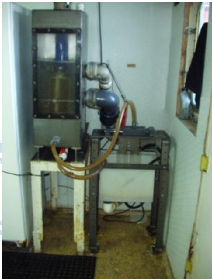
Foto 4. Concentrador (lado izquierdo) y colector (lado derecho) de CUFES en el laboratorio húmedo del B/O Francisco de Ulloa, en operación durante la navegación entre estaciones. Se aprecia el concentrador lleno al 60% de capacidad, el tamiz interior del concentrador, la manguera que conecta al concentrador con el colector, y los dos copos en el colector.
