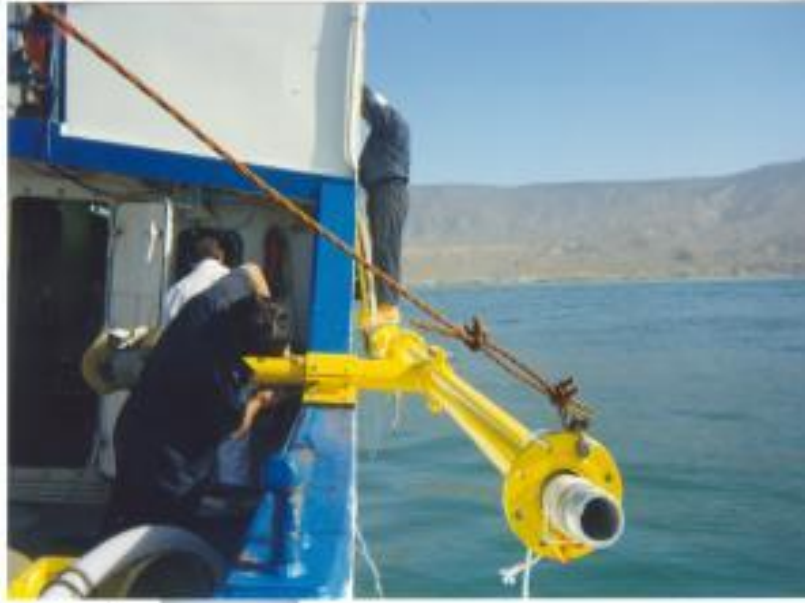
Foto 10. Soporte tubular de la bomba de succión en posición horizontal, sobre la banda de estribor del B/O Francisco de Ulloa.
