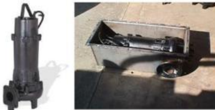
Foto 13. Bomba de succión usada por el sistema CUFES. A la izquierda la bomba Ebara DVSU. A la derecha la misma bomba dentro de la caja metálica (destapada) usada para la instalación interna al casco del barco.
