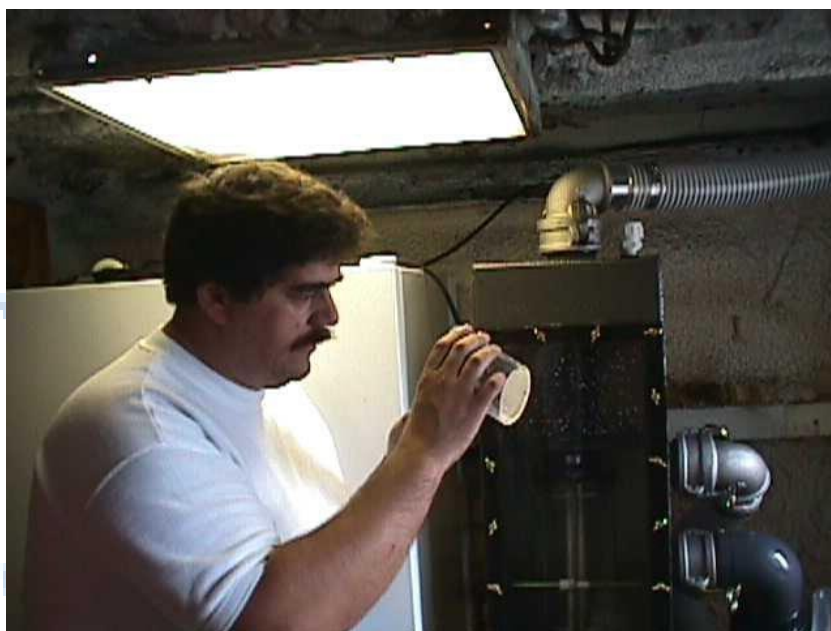
Foto 5. Primera muestra de zooplancton obtenida usando el sistema CUFES, en la Bahía de Todos Santos (Baja California), durante una salida de prueba realizada en marzo de 1999, a bordo del B/O Francisco de Ulloa.
