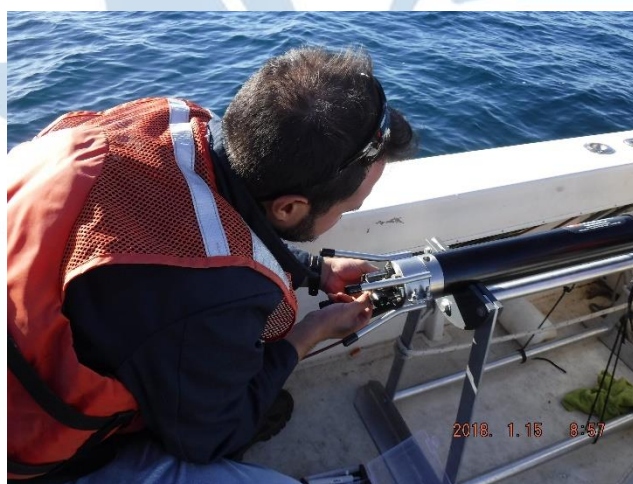
Figura 6.- El M.I. Peláez colocando sensores en el cabezal del perfilador VMP-250 antes de los lances.
