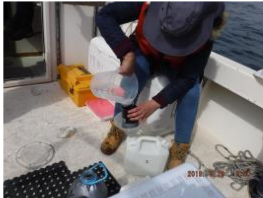
Fig. 7.- Filtrando el agua de superficie.
