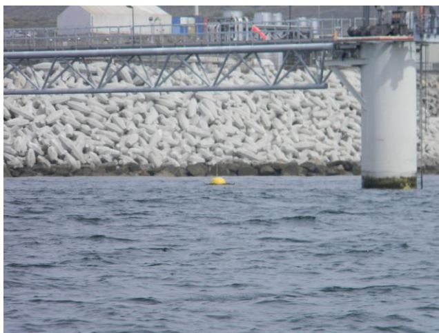
Figura 4.- Boya Datawell Waverider en posición amarrada entre pilotes sur de la terminal marítima ECA.
